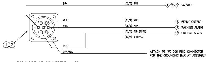
BACK SIDE OF CONNECTOR - C8 -ALARM PORT @ APPLICATOR HOUSING-
