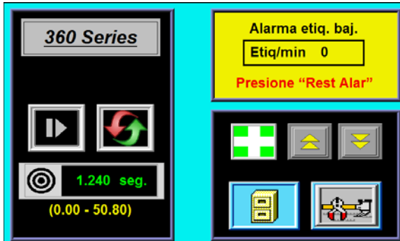
Cuadro de estado de alarma de advertencia
